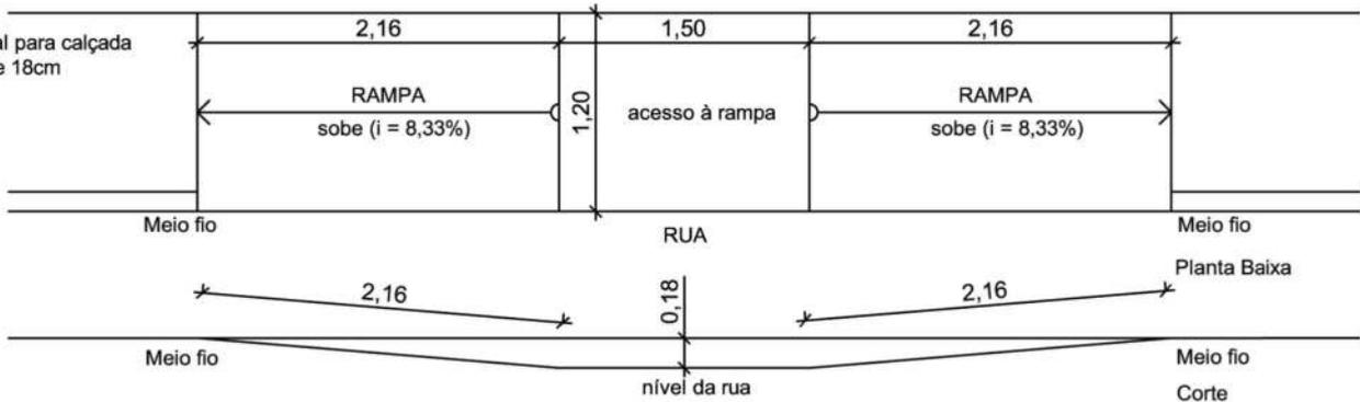
Rampa lateral para calçada com altura de 19cm
